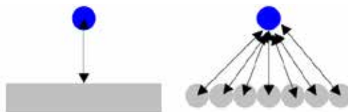
図3 固体のモデル化。左が滑るモデル、右が滑りにくい固体モデルを表す。
