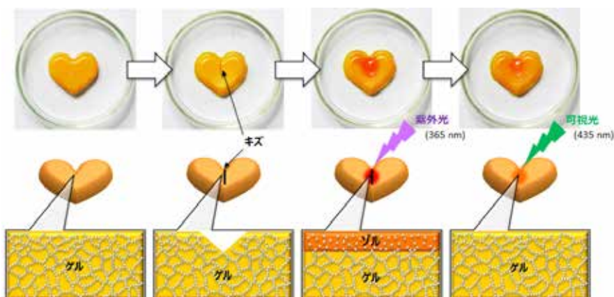
図2 光損傷修復材料(第1世代材料)
