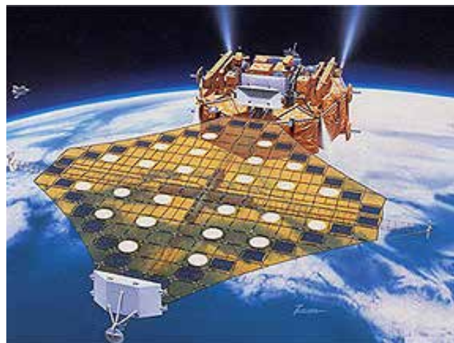
図5 宇宙実験衛星 SFU の2Dアレイの展開実験の様子
